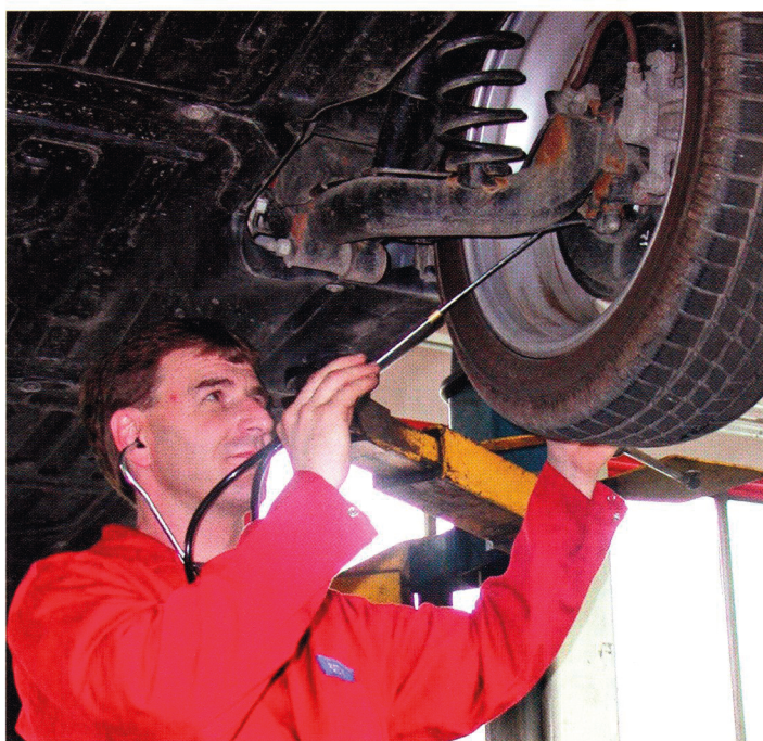
Wenn ungewöhnliche Fahrgeräusche im Achs- bzw. Radbereich zu hören sind, sollten umgehend Überprüfung und Diagnose sowie gegebenenfalls der fachgerechte Austausch defekter Radlager durch einen Kfz-Meisterbetrieb erfolgen. (Foto: SKF)
